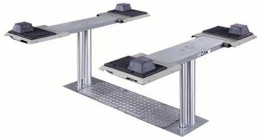
Die **Flachträgerbrücke** mit in Längsrichtung verstellbaren Schiebern eignet sich besonders gut für Reparatur-, Reifen- und Karosseriearbeiten, da das Fahrzeug rundum frei zugänglich ist. Auch unter dem Fahrzeug ist nahezu uneingeschränktes Arbeiten gewährleistet. Die Flachträgerbrücke hat eine Überfahrhöhe von ca. 60 mm und die Schieber sind dreiseitig abgeschrägt. Bereits in der Standardausführung ist die Flachträgerbrücke feuerverzinkt für besten Korrosionsschutz
