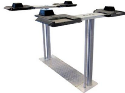
Die **Flachträgerbrücke** mit in Längs- und Querrichtung verstellbaren Schiebern eignen sich besonders gut für Reparatur-, Reifen- und Karosseriearbeiten, da das Fahrzeug rundum frei zugänglich ist. Auch unter dem Fahrzeug ist uneingeschränktes Arbeiten gewährleistet. Die Flachträgerbrücke hat eine Überfahrhöhe von ca. 70 mm und ist dreiseitig abgeschrägt. Die Längsträger sind feuerverzinkt und die Schieber lackiert lieferbar.
